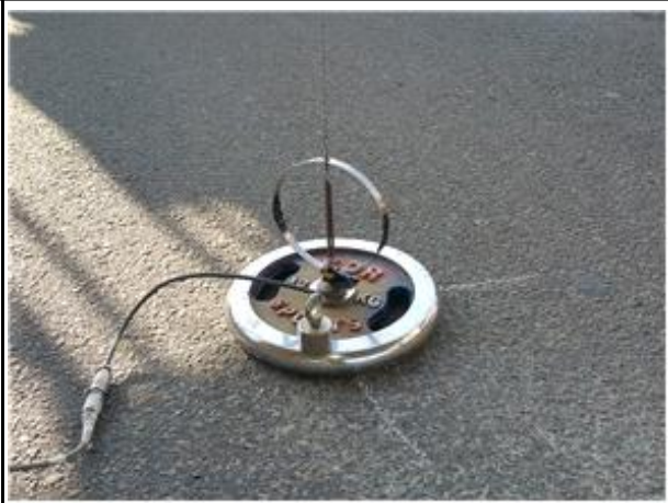
처짐계 설치 현황
