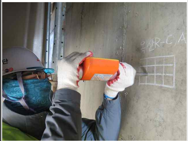
반발경도측정 시험 전경
