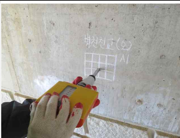
반발경도측정 시험 전경
