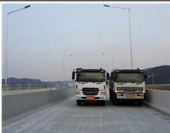
정적 재하시험 전경
