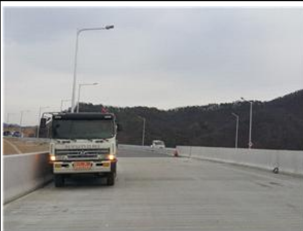
정적 재하시험 전경
